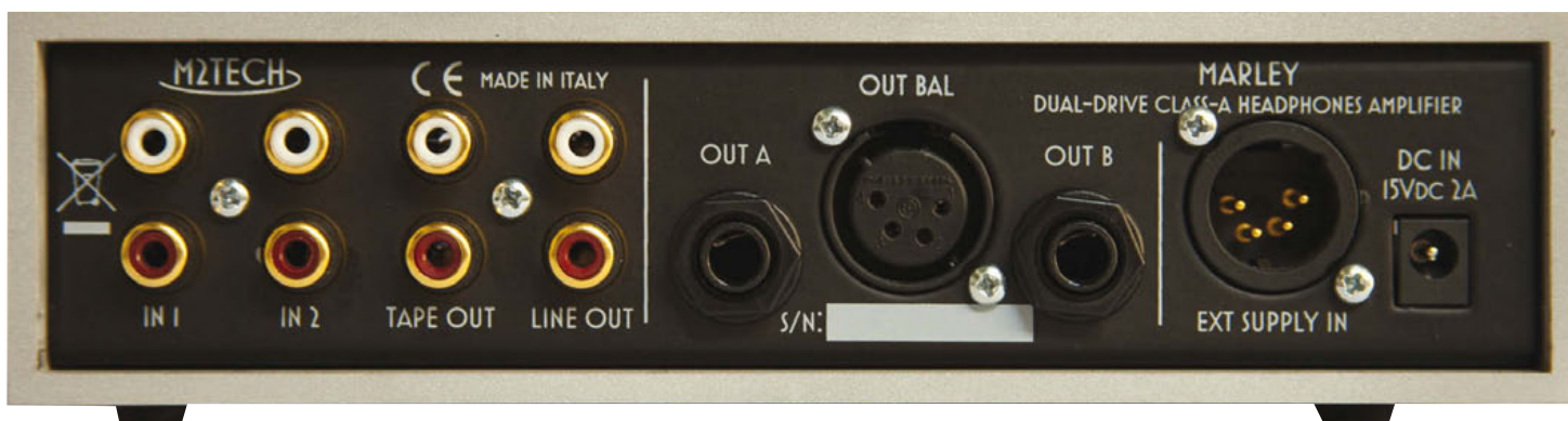
Il pannello posteriore accoglie tutte le prese di collegamento, a partire da 2 coppie di ingressi e 2 di uscite (una diretta e una controllata dal volume); 2 prese jack stereo per cuffie più una bilanciata, e 2 connettori per alimentatori esterni.
