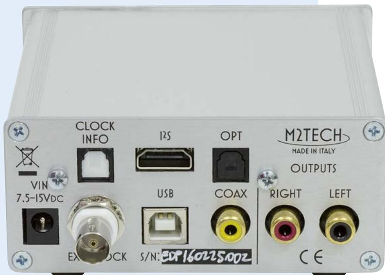
Sul retro dell'Evo DAC Two Plus abbiamo ingressi S/PDIF coassiale e ottico, USB e I<sup>2</sup>S su presa HDMI.
