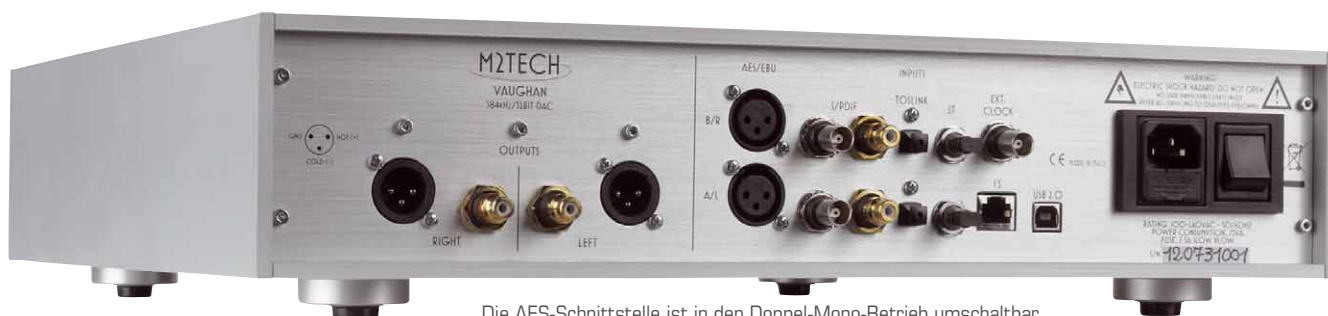
Die AES-Schnittstelle ist in den Doppel-Mono-Betrieb umschaltbar, das passende Quellgerät dafür kommt sicher noch
