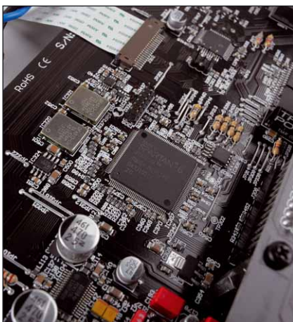
Oversampling und Filterung finden in einem FPGA statt
